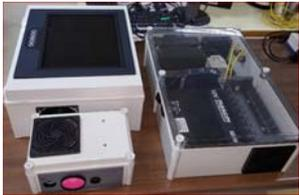
Sistemas de detección ópticos integrados y conectados con el procesador y la pantalla de visualización
