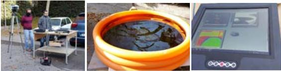
Sistemas de detección ópticos observando un vertido de crudo en las instalaciones del CEDEX, junto con la visualización de las imágenes capturadas
