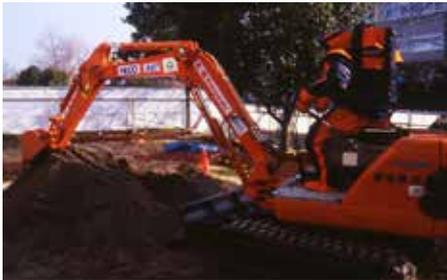
Control remoto de una excavadora utilizando un robot humanoide (IHI, Kawazaki Heavy Industries, Tokyu Construction, AIST).
