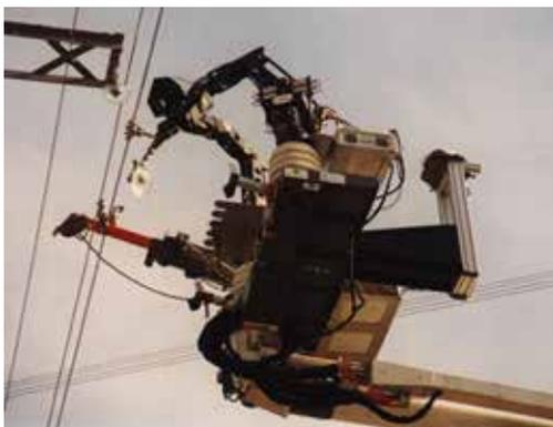
Robot ROBTET para mantenimiento de líneas eléctricas (Cortesía DISAM-UPM)
