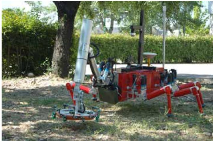
SILO6: robot hexápodo para desactivación de minas anti-persona (Cortesía IAI-CSIC)
